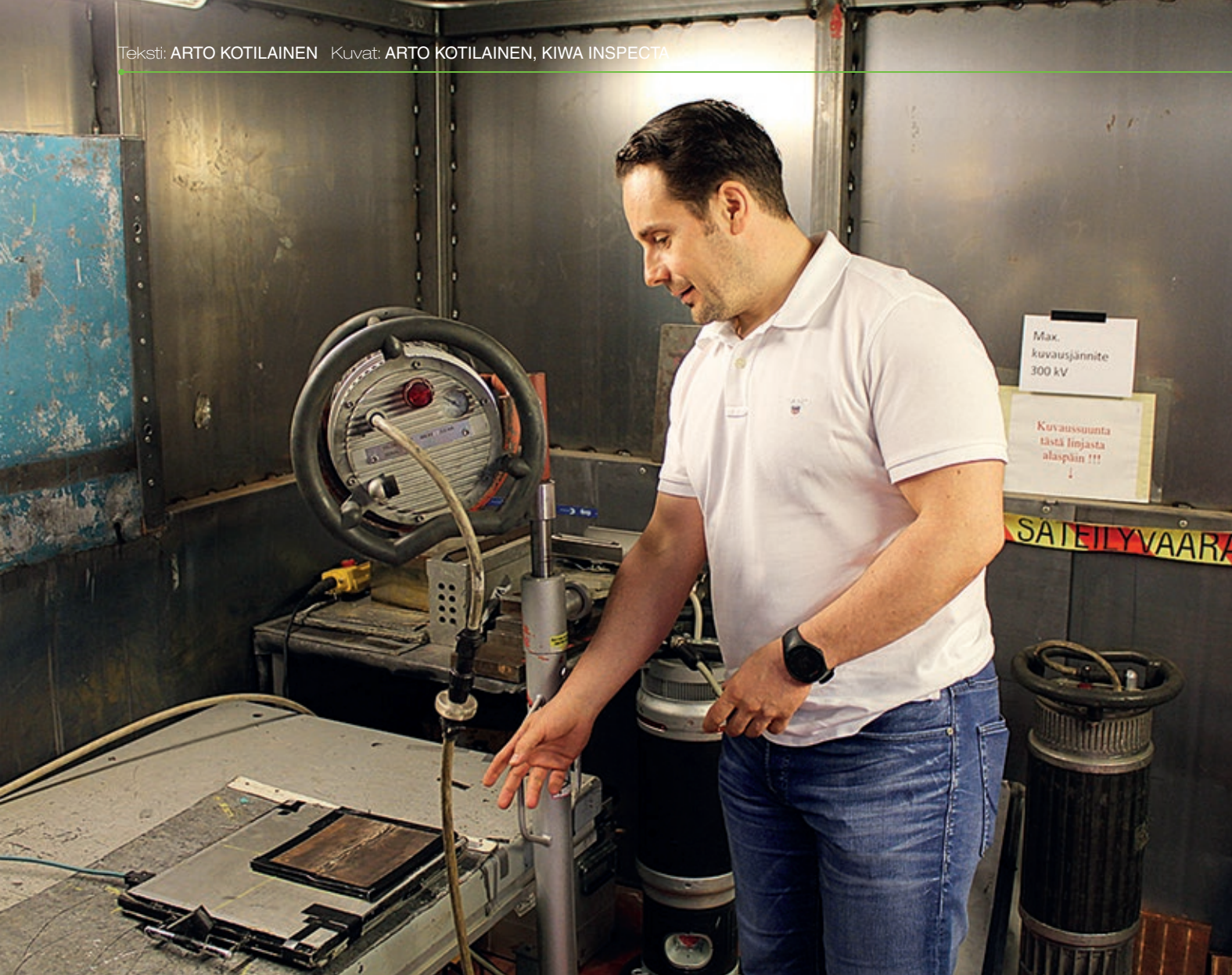
Digitaalista röntgeniä voidaan Janne Pirilän mukaan käyttää esimerkiksi käyttövesiputkistojen tarkistuksissa
